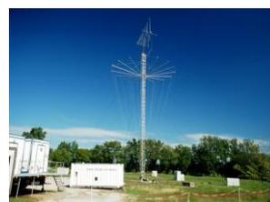
Antenne large bande pour tests électromagnétiques
